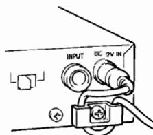
DC 12V IN端子にPA-1207のプラグを差し込んだ後、コードを巻き付ける。
