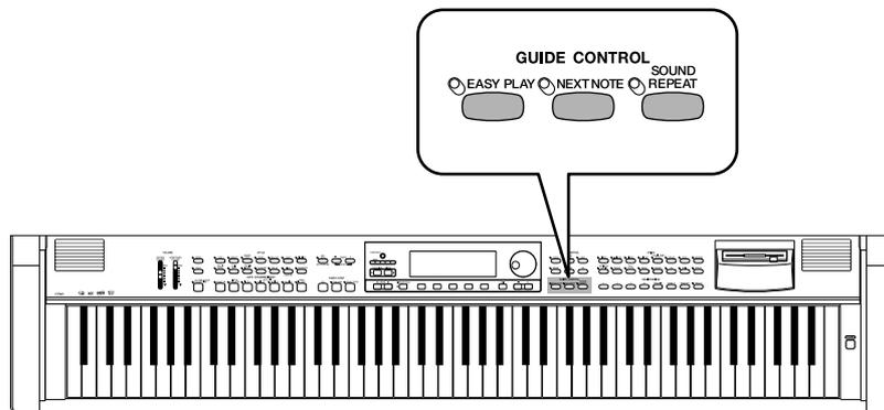
ここでは、ディスクソフトを使って演奏の練習ができる、ガイド機能の3段階ステップアップ練習を体験します。LCD画面に表示される"ピアノロール"と"鍵盤ガイドランプ"によって、鍵盤を弾くタイミングや音符の長さ、押さえる鍵盤位置を示してくれます。さらに、正しい鍵盤を押さえるまで伴奏が待っていてくれますので、マイペースで練習することができます。
