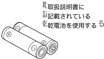
また、種類の違う乾電池、新しい電池と古い電池を混ぜて使用しないでください。電池の破裂、液もれにより、火災・けがや周囲を汚損する原因となります。
