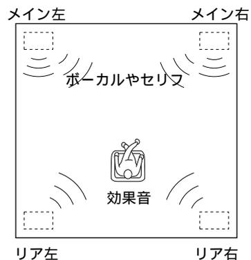
TVの両側にメインスピーカーを設置するような、スピーカーの間隔が比較的狭い場合は、センタースピーカーを使用しなくても十分な効果が得られます。センターモードはNONEに設定します(25ページ)。
