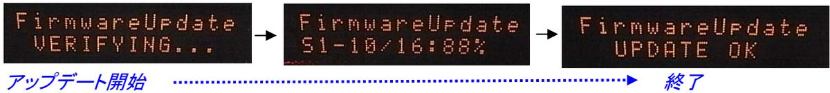
**ご注意！** アップデート中は電源を切ったりUSBメモリを抜かないで下さい。万が一アップデート中に電源を切ってしまった場合には最終ページの「エラーが発生した時の対処方法」を参照し、再度アップデートを行ってください。
