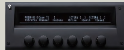
▲写真⑧ 画面下段の6つのパラメーターは、その音色を変化させるにあたって一番最適なものがあらかじめセットされている(任意のパラメーターに変更可能)。このプリセットB-1“Case 71”の場合は、ハンマーの打弦ポイント(StrkPos)や硬さ(Hammer)、出力音量(Volume)、パワー・アンプの歪み(Drive)、ピブラートの深さ(Depth)と速さ(Speed)がアサインされており、これらのパラメーターを中央の6つのノブで操作することができる。
