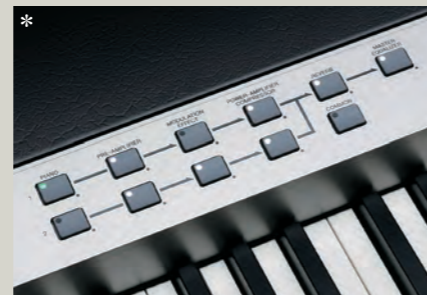
▲写真③ CP1の音色を構成する4つのブロックは、その流れに沿ってボタンで表示。ピアノ・ブロックは“PIANO”と“PRE-AMPLIFIER”からなり、“MODULATION EFFECT”、“POWER AMPLIFIER/COMPRESSOR”、“REVERB”と続き、そして最終段に“MASTER EQUALIZER”が用意されている。ボタンのインジケータが点灯していると、そのブロックはオンになっている状態。
