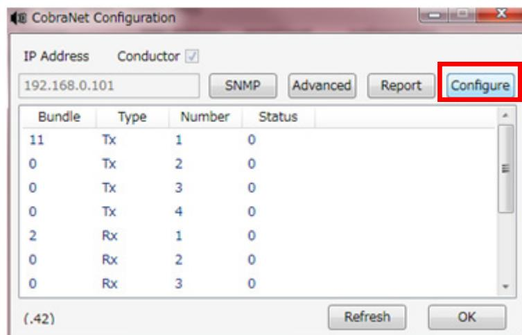
2 Number 1 の Tx バンドルを選択して、ダブルクリックまたは、[Configure]をクリックします。
