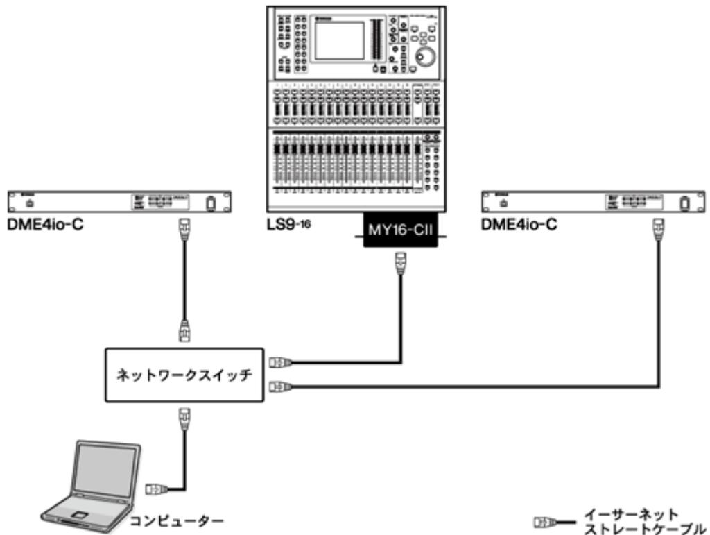
**NOTE** コンピューターと CobraNet 対応機器を直接接続する場合は、クロスケーブルを使用してください。
