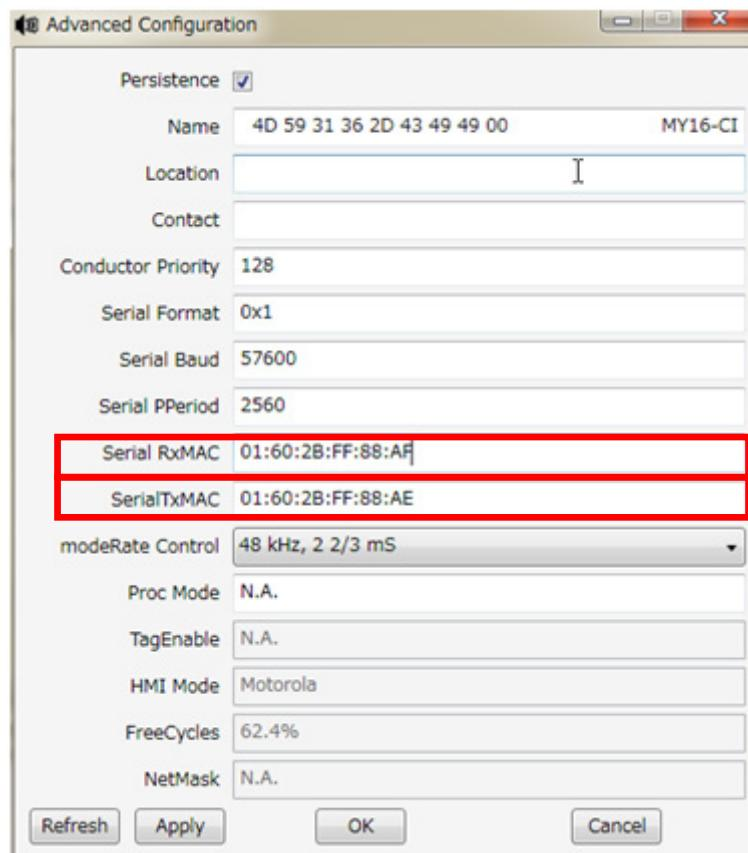
3 下表を参考にして、SerialTxMAC フィールド(送信側)と SerialRxMAC フィールド(受信側)のシリアルチャンネル番号が一致するよう入力します。
