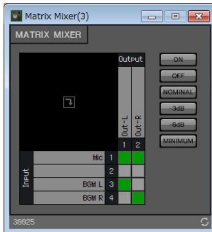
**29. 「Matrix Mixer(3)」の出力ポートと「OUT」の入力ポートをドラッグ&ドロップして結線する。**
