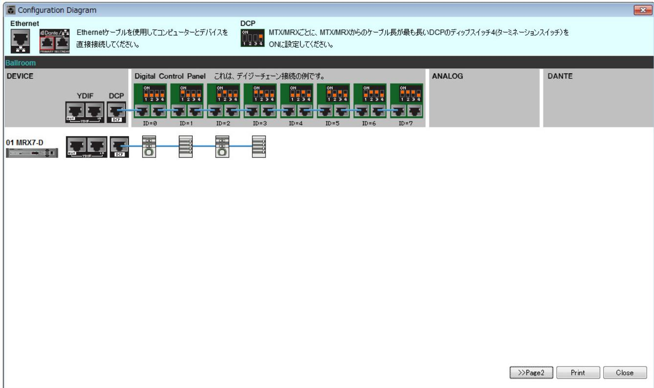
DCPのディップスイッチを結線図の「Digital Control Panel」で指示されているように設定してください。
