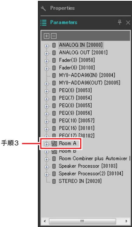
**3. Room AのAUXのレベルは、Room Aの「Fader(2)」で調整するので、「Parameters」エリアの [Room A]→[Fader(2)]を開く。**
