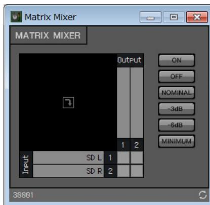
6. Input 1と2をOutput 1に出すように設定して、Output 1に「SD」と記入したあと、右上にある[X]ボタンをクリックして、コンポーネントエディターを閉じる。
