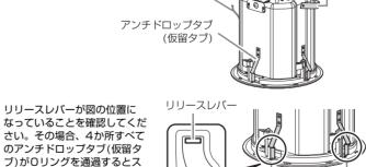
さい。その場合、4か所すべて のアンチドロップタブ(仮留タ ブ)がロリングを通過するとス ピーカー本体がロリングに仮留 ンチドロップタブ(仮留タブ) スピーカーを上に持ち上げながら、ブラスドライバーを時計回りに回して4か所の固定ネジを締めます。固定ネジは マークが指しているネジです。
