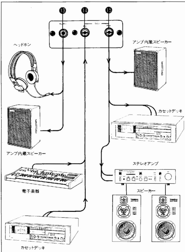
※ラインインジャック、ラインアウトジャックはピンジャックです。規格の違うプラグを接続する場合(電子楽器、アンプ内蔵スピーカーなど)には、プラグアダプター(市販品)を使用して下さい。
