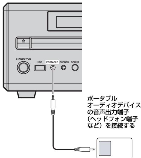
ポータブルオーディオデバイスの音声出力端子（ヘッドフォン端子など）を接続する
