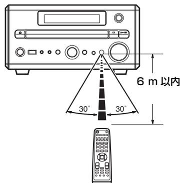
リモコンで本機を操作する際は、リモコンの赤外線送信部を本体のリモコン受光窓（3ページ）に向けます。リモコン操作が可能な範囲は、本体から6m以内で正面から左右に30度以内です。
