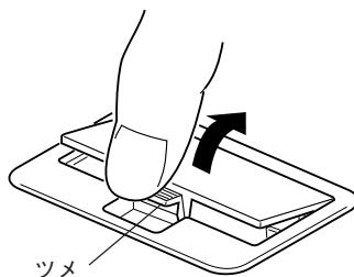
① バッテリーホルダーのツメを上図の矢印の方向へ押して、ロックを解除します。
