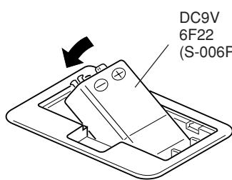
② バッテリーケースから電池を外し、新しいものと交換します。
