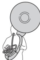
1. ベル止めネジを緩めてベルの両端をしっかりと持ち、ゆっくり回しながら管体に差し込みます。セットした後、3本のベル止めネジを同じ力で締めて止めます。
