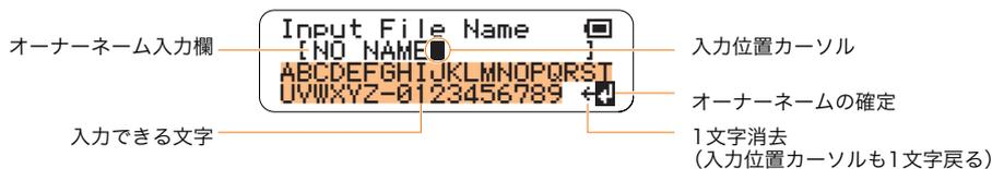
2 オーナーネームを付け終わったら、ジョグダイヤルを回して液晶ディスプレイ4行目右端に表示される “↵” を選び (反転表示)、[OK] ボタンを押します。
