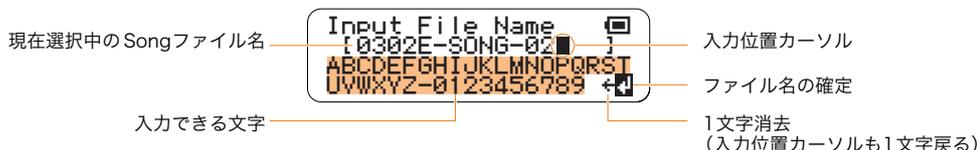
液晶ディスプレイ2行目のファイル名に表示されるカーソル(■)が入力位置となります。ジョグダイヤルを使って液晶ディスプレイ3-4行目に表示される文字列から文字を選び(反転表示)、[OK]ボタンを押して文字を入力します。文字が入力されると入力位置カーソルが1文字分右へ移動します。カーソルは入力した文字の右横にしか表示されませんので、途中の文字を変更したい場合は、変更したい文字まで削除し、そこから入力直してください。文字を削除するには、ジョグダイヤルを使って液晶ディスプレイ4行目右端に表示される“\*”を選び(反転表示)、[OK]ボタンを何度か押してください。設定できるファイル名は半角英数字と“-”(ハイフン)のみ、拡張子を除いた最大16文字までです。拡張子は自動的に付けられます。
