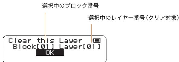
現在選択中のブロックの、現在選択中のレイヤーの発音ポイントを消去します。この機能は [CLEAR] ボタンの短押しと同じです。
