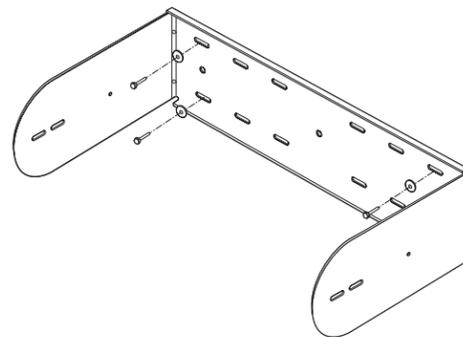
5. 図のようにスピーカーU型マウント金具の間に置いて、付属の金具を取り付けます。
