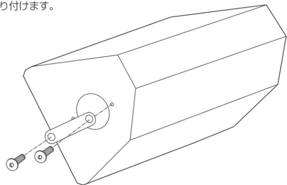
2. U型マウント金具のサイズがスピーカーに合っているか、金具とスピーカーの間に入れるパッキングのスペースがあるか確認します。
