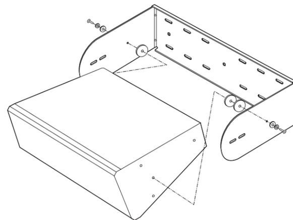
6. スピーカーの角度を調整したあと、留め具をしっかりと締め付けてスピーカーを固定します。
