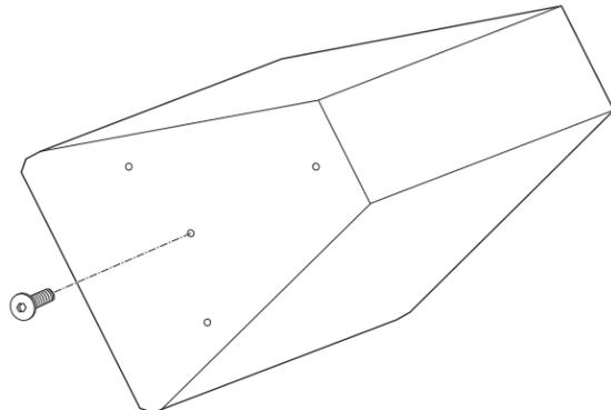
IF2115/AS(W)スピーカーの場合は、ソケットカバー金具をスピーカーに取り付けます。
