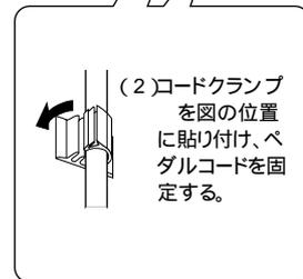
(2) コードクランプを図の位置に貼り付け、ペダルコードを固定する。
