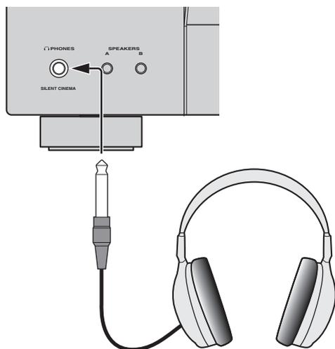
「サイレントシネマ」モードでは、マルチスピーカーによる音場プログラムの効果を、ヘッドホンで擬似的に再現します。「サイレントシネマ」モードで再生している間は、本体ディスプレイの SILENT CINEMA インジケーターが点灯します。
