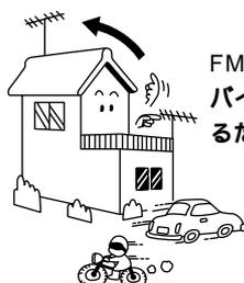
FMアンテナを雑音源 モーターバイクや自動車から離してできるだけ高く設置する
