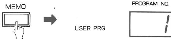
②USER PROGインジケータとPROGRAM No.ディスプレイが点滅している間に、1~20の中のお好きなNo.のプログラムキーを押してください。プログラムは、押されたプログラムキーと同じNo.にメモリされます。
