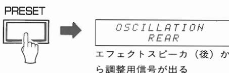
⑤②から④の操作を繰り返し、スピーカを切り替えたときの音量差が少なくなるように、各パワーアンプのボリュームを調整します。
