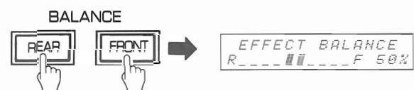
\*この調節は、トータルレベル/バランス調整(プログラム全体の調整)とは異なり、プログラムごとに設定されます。また、後からトータルレベル/バランス調整を行なうと、全プリセットプログラムのエフェクトレベル/バランスはリセットされます。(すべてのプリセットのEFFECT LEVEL、EFFECT BALANCEが調整された値にリセットされます。)ご注意ください。なお、ユーザープログラムのエフェクトレベル/バランスはリセットされません。
