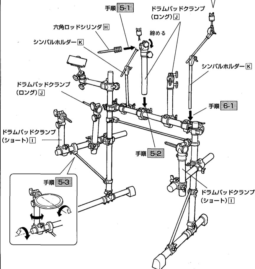
組み立てが完成したら、キックパッド、ハイハットコントロールペダルなどをセットし、結線します。各ケーブルは、演奏のじゃまにならないようケーブルバンドでパイプに固定しましょう。
