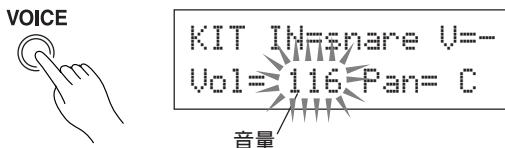
音量を設定したいパッドを叩き、[ VALUE - ]/[ VALUE + ]を押して音量を調整します。
