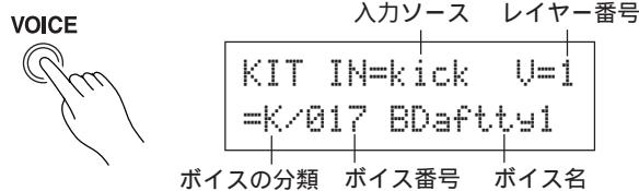
[SEL◀]/[SEL▶]を押して入力ソースを点滅させ、[VALUE -]/[VALUE +]を押して"snare"を選びます。これは、トリガー入力端子の2 SNAREに接続しているパッド入力、つまりスネアのパッド入力を選んでいます。
