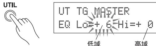
[ SEL◀ ]/[ SEL▶ ]を押して高域か低域を点滅させ、[ VALUE - ]/[ VALUE + ]を押してその音質を設定します。
