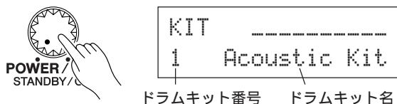
スピーカー保護のため、DTXPRESS IIの電源を先に入れ、その後ミキサー・アンプの順でオーディオ機器の電源をオンにしてください。
