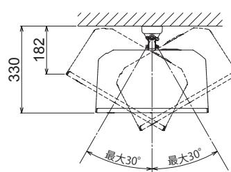
※垂直方向の下向き振り角度が30°以下の場合、付属のストップネジをマウンティングブラケットに取り付けて固定してください。
