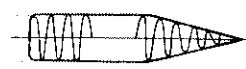
上の電氣的スイッチの音にサステイン効果をつけたとき減衰音がえられる
