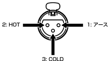
接続の際には必ずピンどうしを合わせ、XLR コネクター（オス）を「カチッ」と音がするまで差し込みます。接続を外す際は、CD BAL 端子のレバーを押しながら XLR コネクター（オス）を抜きます。
