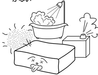
加湿器を使用する場合は、本機との間に十分なスペースをとり、加湿しすぎないようにしてください。本機内部に結露が生じると故障するだけでなく、火災・感電の原因となります。
