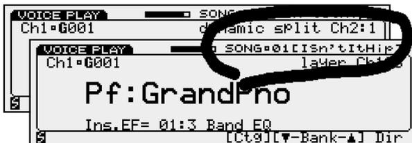
ボイスモード、またはキーボードセットアップ画面で、①~⑯がトラックセレクトボタンとして機能していて、キーボードモードが“norm”時、①~⑯を2つ押すと、キーボードモードが“split”に切り替わります。先に押したトラックがUpper、後に押したトラックがLowerになります。キーボードセットアップ画面で、①~⑯を2つ押しながら鍵盤を押さえると、その鍵盤がスプリットポイントになります。
