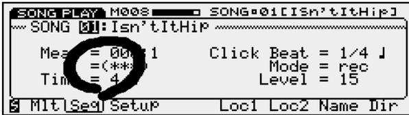
曲の途中から再生する場合、[SHIFT] + [RUN]を押すと、セットアップデータを反映してから、ソングデータを再生するようになりました。これにより、再生開始位置までのソングデータの未消化を解消しています。
