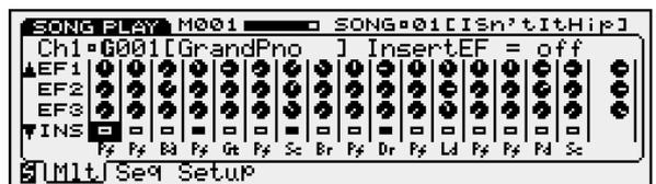
W5/W7の6台のエフェクターは、システムエフェクトとインサージョンエフェクトの2種類に分類されます。
