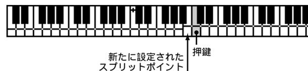
**注意!** ダイナミクスプリットのモードが“ 1stL ” “ 1stU ”の場合、いずれの鍵域も押されていない状態から押鍵すると、また上記条件によりスプリットポイントが設定されます。
