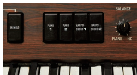
◀CP-20のパネル部分。4つの音色タブレット(ピアノ1、ピアノ2、ハーブシコード1、ハーブシコード2)を備え、それぞれを組み合わせることも可能(撮影:菊地英二)
