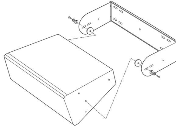
6. スピーカーの角度を調整したあと、留め具をしっかりと締め付けてスピーカーを固定します。
