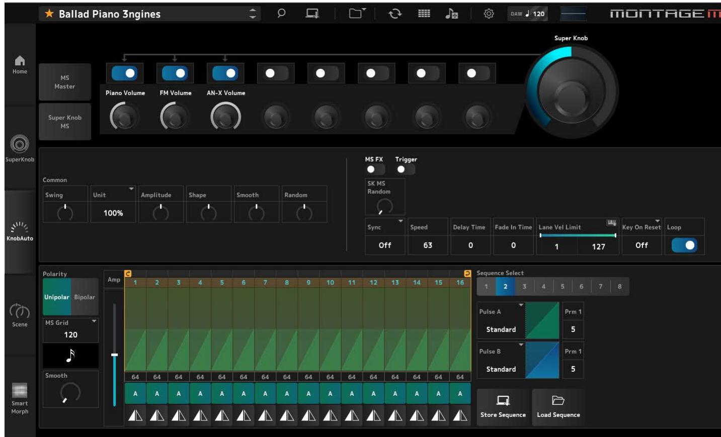
Knob Auto画面では、スーパーノブに適用されるモーションシーケンサー（スーパーノブモーションシーケンサー）を設定できます。各パラメーターの詳細はMONTAGE MおよびMODX Mのオペレーションマニュアルをご参照ください。
