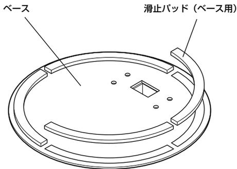
**2** ベース取付用ネジ (専用ミリネジ) でサポートの底部とベースを取り付けます。
