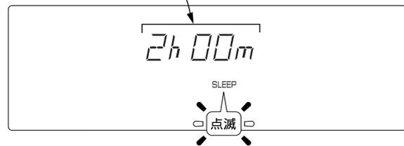
押すたびに、 2h00m 1h30m 1h00m 0h30m OFF SLEEP と変わります。
