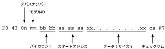
1.上記のスタートアドレスとデータ部分の16進数を、下の「10進数16進数変換表」を使って10進数に変換します。(変換するのはアンダーラインの部分です)
