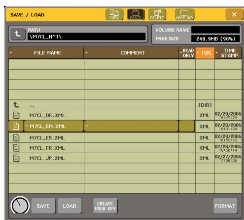
4 ファイルリストに表示されたヘルプファイルを押す、またはパネル上のマルチファンクションエンコーダー1を回して、ロードしたいヘルプファイルを選択します。
