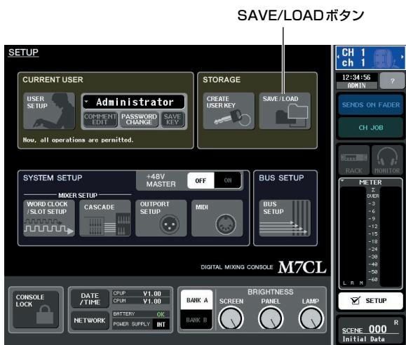
3 SAVE/LOADボタンを押して、SAVE/LOAD ポップアップウィンドウを表示させます。
