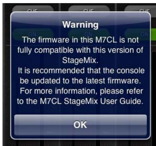
古いバージョンの M7CL をお使いの場合は、Channel Select Follow 機能を無効にしてください(4.2.4 章および 4.2.5 章を参照)。また、チャンネルリンクを組んだ状態で本体の [SEL]キーを使ってチャンネルの相対オフセットを変更した場合、StageMix はそのオフセットを認識しません。これによってチャンネルリンクが正しく動作しなくなります。
