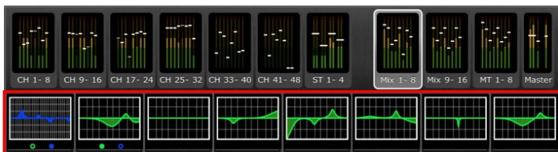
各 EQ カーブの下部にある緑と青の点は、該当チャンネルで使用可能な EQ のタイプと、そのチャンネルに現在表示されている EQ (PEQ および GEQ) のタイプを示しています。緑の点は PEQ を、青い点は GEQ を意味します。あるチャンネルで PEQ のみが使用可能な設定の場合、EQ カーブの下部の点はいずれも表示されません。(デモモードでは、GEQ が MIX バス 1、7 および 8 に表示されます。)
