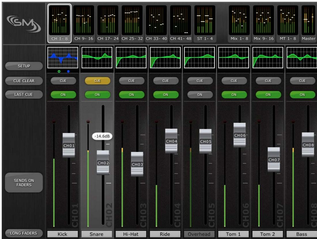
画面上部には、レベルメーターとフェーダーがブロック(mono インプットチャンネル 1-48、Stereo インプットチャンネル 1-4、MIX/MATRIX バス、Master Stereo、Mono バス)に分かれて表示されています。これを「ナビゲーション/メーターブリッジ」といいます。
