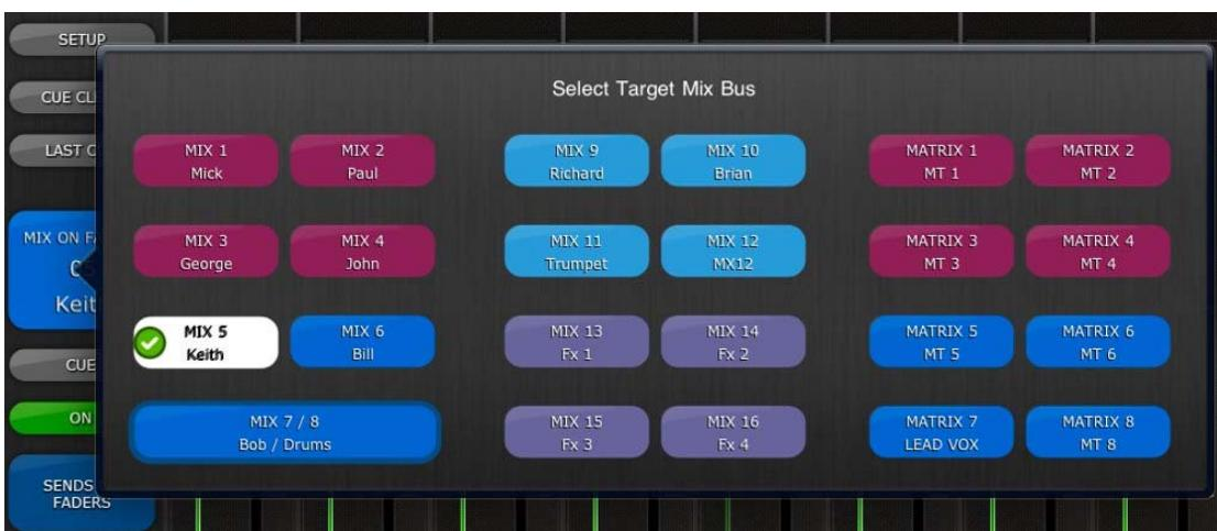
MIX 1-16 および MATRIX 1-8 から選択できます。チェックマークの付いた白いボタンが現在選択されている MIX です。ステレオペアに設定されている MIX はひとつの大きなボタンとして表示されます。
