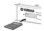
SDメモリーカードが正常に認識されると、[SD/ ACT]インジケーター (9ページ)が点灯します。また、 カードにアクセス中は[SD/ACT]インジケーターが点 滅します。
