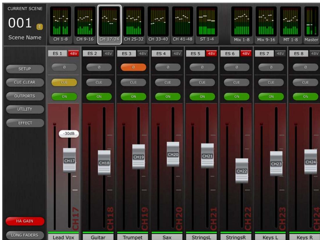
フェーダーを動かすことにより HA ゲインをチャンネルごとに変更できます。フェーダーノブにタッチすると、各ヘッドアンプのゲイン値がフェーダーの上部に表示されます。最大 8 つまでのフェーダーが同時に使用可能です。
