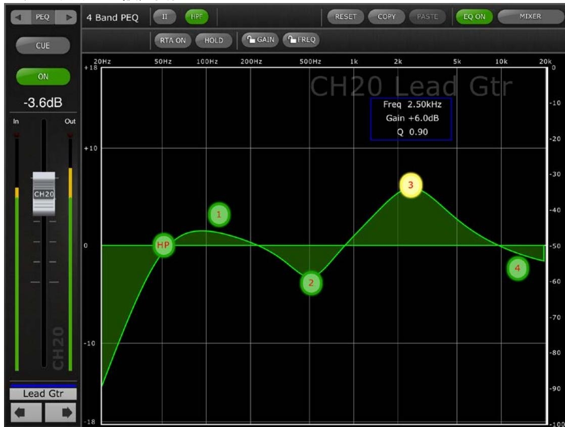
左側に、現在選択されているチャンネルの名前、色、フェーダー、レベルメーター、[ON] ボタン、[CUE] ボタンが表示されます。左下には「戻る」「次へ」を意味する左右の矢印ボタンが表示され、これを使うとほかのチャンネルに移動できます。
