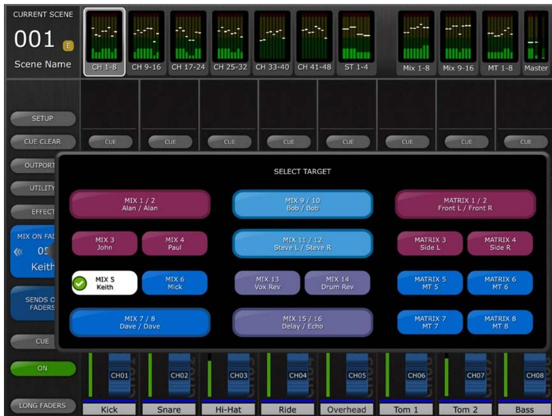
MIX 1-16 および MATRIX 1-8 から操作対象のバスを選択できます。チェックマークの付いた白いボタンが現在選択されている MIX です。ステレオペアに設定されている MIX はひとつの大きなボタンとして表示されます。
