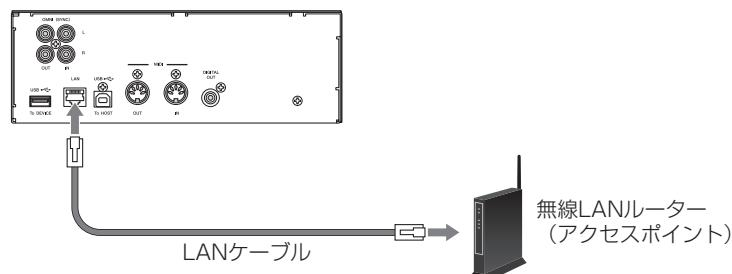
(アップライトピアノの場合) LANケーブルを使って、インレットボックスのLAN端子に無線LANルーター（アクセスポイント）を接続します。
