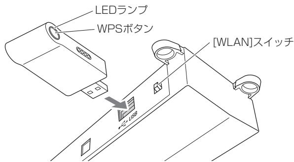
**3** スイッチボックス背面の[WLAN]スイッチが「RT」に設定されていることを確認します。
