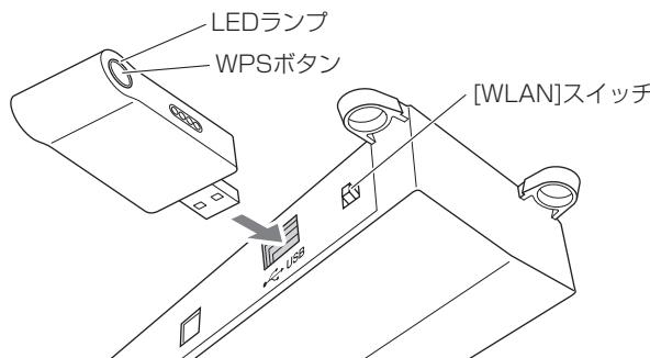
3 スイッチボックス背面の[WLAN]スイッチを「AP」に設定します。
