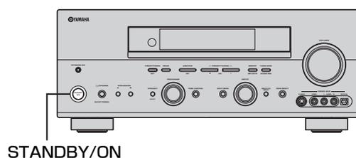
本体のSTANDBY/ONスイッチ（またはリモコンのSYSTEM POWERキー）を押します。
