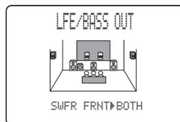
LFE 信号を出力するスピーカーを設定します。LFE 信号は、ドルビーデジタルや DTS、AAC の音声に含まれる 120Hz 以下の低域効果音のことで、サブウーファーとフロント L / R スピーカーへ出力されます。
