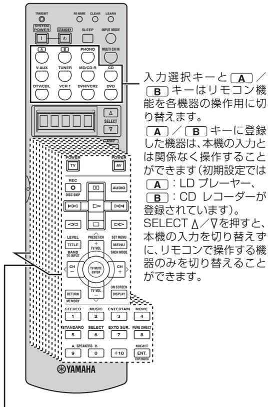
入力選択キーと **A** / **B** キーはリモコン機能を各機器の操作用に切り替えます。
