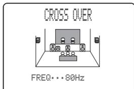
サブウーファーに出力する低音成分の、周波数の上限を設定します。設定した周波数以下の低音成分が、サブウーファーまたはフロント L/R スピーカーに出力されます。
