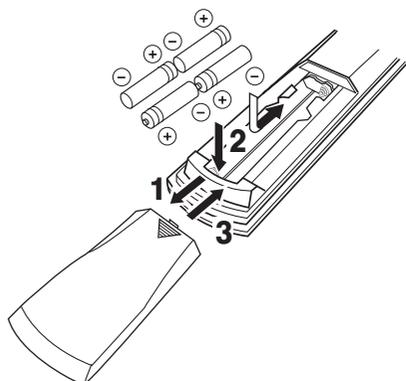
**1** リモコンの電池カバーの▼マークを押しながら、カバーをリモコンから取りはずす。
