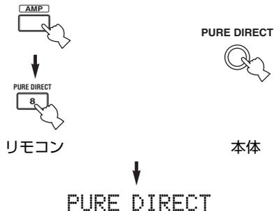
ピュアダイレクトモードで再生している間は、本体のPURE DIRECTキーが青色で点灯します。
