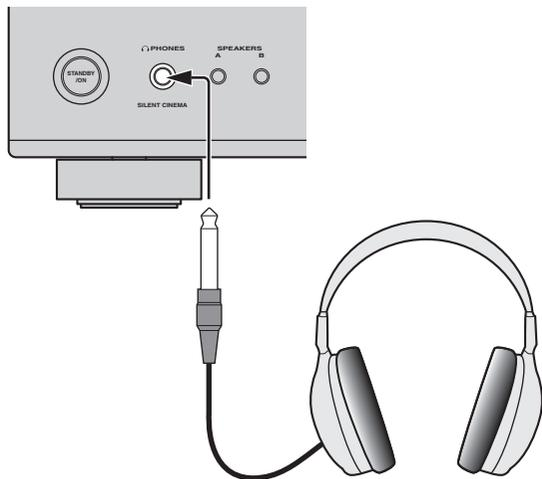
「サイレントシネマ」モードでは、マルチスピーカーによる音場プログラムの効果を、ヘッドホンで擬似的に再現します。「サイレントシネマ」モードで再生している間は、本体ディスプレイのSILENT CINEMAインジケーターが点灯します。
