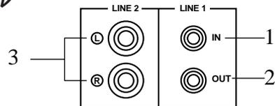
LINE 1 IN: 付属の3.5 mmステレオミニプラグケーブルを使って、本機へ信号を入力します。
