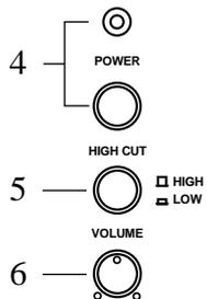
**POWERスイッチ/インジケータ:**POWERスイッチを押すと、電源が入り、インジケータが点灯します。スイッチをもう一度押すと、電源が切れます。
