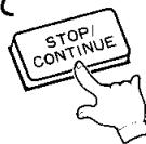
パターンプレイとソングプレイは、STOP/CONTINUEキーを押すことにより停止します。もう一度このキーを押すと、停止した箇所よりプレイを再開します。
