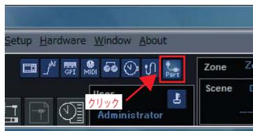
「Port」ウィンドウが表示されたら、下図のようにTx、Rx、デバイスグループ設定を確認します。空欄がある場合には、クリックしてオプションのリストを表示し、適切なオプションを選択します。
