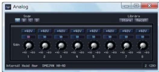
初期設定では、ゲインは+10dBuに設定されています（設定可能な最低レベル）。接続したオーディオ機器に適合するレベルに感度を調整します。
