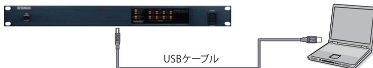
IPアドレスの設定が完了するまで、デバイスをネットワークに接続しないでください。IPアドレスの設定は、USBケーブルを用いてパソコンを各デバイスに順番に接続して行います。
