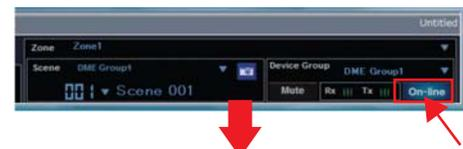
「Select IP Address」をクリックし、全てのデバイスのIPアドレスが表示されていることを確認し、[Go On-Line]ボタンをクリックします。「Sync Direction」ウィンドウが表示されたら、[DME Designer -> Device]が選択されていることを確認し、[OK]ボタンをクリックします。
