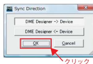
「Sync Direction」ウィンドウが表示されたら、[DME Designer -> Device]が選択されていることを確認し、[OK]ボタンをクリックします。
