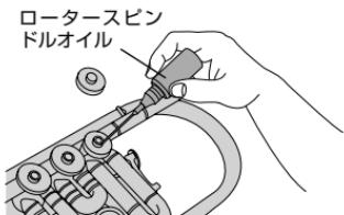
2. ローター回転軸と受軸にも、ロータースピンドルオイルを注油します。キャップを締めたら、オイルがはじむようにレバーを2～3回動かします。
