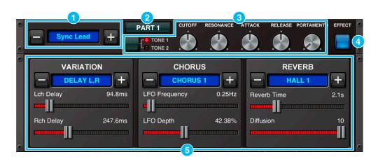
① 表示されている音色名をタップすると、音色リストが表示されます。 音色リストにある音色名をタップすると選択されている PART (パート) の音色が 切り替わります。音色名表示の両脇にある [−]、[+]をタップして音色を切り替 えることもできます。
