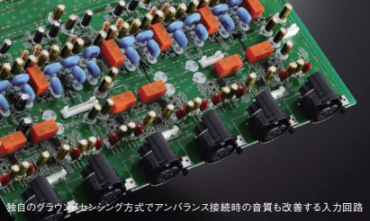
独自のグラウンドセンシング方式でアンバランス接続時の音質も改善する入力回路
