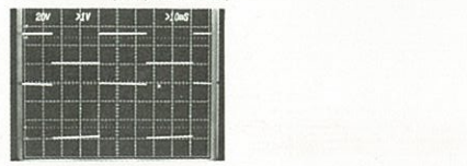
写真18 トーンバースト応答特性 (10kHz:100W出力時) 写真19 立ち上り特性
