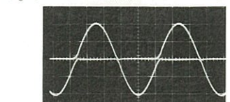
Fig 14 B.P Tr電流波形100kHz 70w時(参考)
